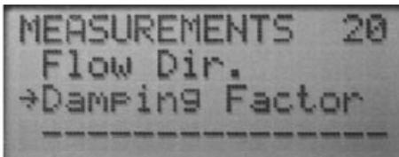
1. In der "MEASUREMENTS 20" Anzeige den Pfeil auf "Damping Factor" navigieren.
