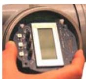
3. Anzeigenplatine an den Halteklammern ca. 45 Grad nach oben kippen und dann herausziehen.
