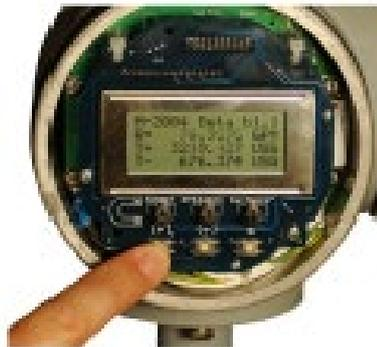
Es ist entweder ein Magnetstift zur Betätigung der + (plus), - (minus)- und **E**-Schalter zu verwenden. Der Deckel für die Anzeige des Verstärkers wird hierbei nicht abmontiert.
