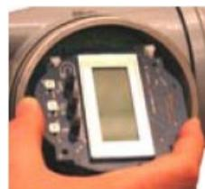
7. Anzeige zwischen den Halteklammern einschieben. Platine wieder korrekt positionieren und mit Schrauben und Unterlegscheiben sichern.
