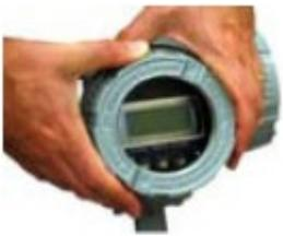
2. Die 2 Schrauben und die Unterlegscheiben entfernen. (HINWEIS: Einen Schlitzschraubendreher verwenden, um ein Hineinfallen der Schraube in das Gehäuse zu vermeiden.)
