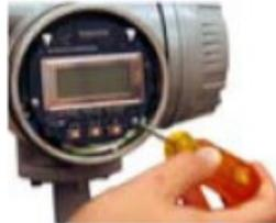
3. Anzeige an den Halteklammern ca. 45 Grad nach oben kippen und herausziehen.
