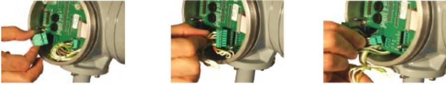
5. Die Anschlüsse für die Stromversorgung, die Spule und für die Elektrode sowie die I/O-Anschlüsse und Kabelbäume von der Verbindungsleiterplatte trennen.
