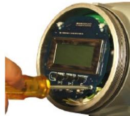
3. Anzeigeplatine an den Halteklammern ca. 45 Grad nach oben kippen und dann herausziehen.
