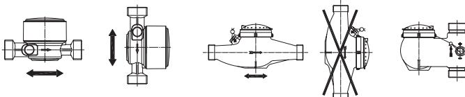
2. Un tronçon d'entrée et de sortie ne sont pas nécessaires pour le compteur d'eau.
