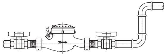
11. Bei vielen Installationen dienen Wasserleitungen als Masse für elektrische Anlagen. Entsprechend der vorliegenden Situation ist eine elektrische Überbrückung des Wasserzählers zu gewährleisten.
