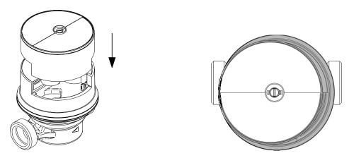
Das Modul durch sanften Druck nach rechts schieben, bis es hör- und fühlbar einrastet. Die Modulaußenkanten schließen nach dem Einrasten mit den Außenkanten des Zählwerks bündig ab.
