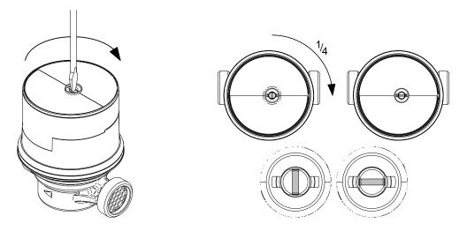
Um das Modul gegen vorsätzliche Demontage zu sichern kann eine Steckplombe verwendet werden. Diese in die "Schlitzschraube" in der Deckelmitte fest eindrücken.
