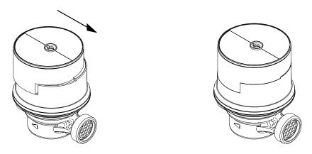
Das Modul kann durch eine integrierte Verriegelung gegen unbeabsichtigte Demontage gesichert werden. Dazu mit einem kleinen Schlitz-Schraubendreher die "Schraube" in der Deckelmitte um 90° nach rechts drehen.
