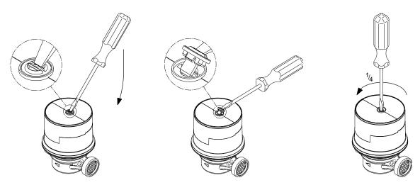
Danach das Modul durch schieben nach links lösen und senkrecht nach oben vom Zähler abnehmen.
