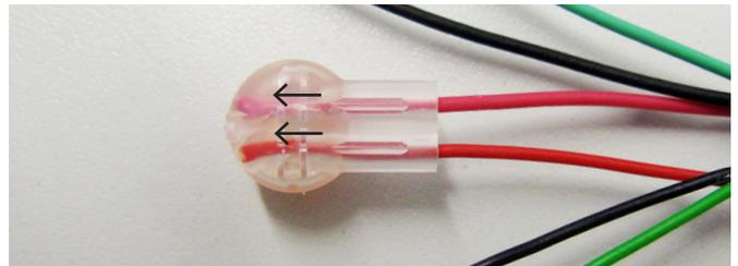
3. Mit einer Wasserpumpenzange die Klemme zusammen-drücken.
